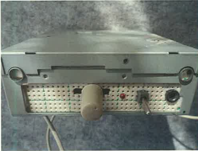
MD Drive のケースに組み込む
