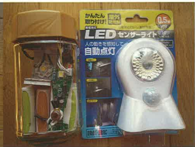
コーヒの空きビンに組み組む 市販LEDセンサーライ
