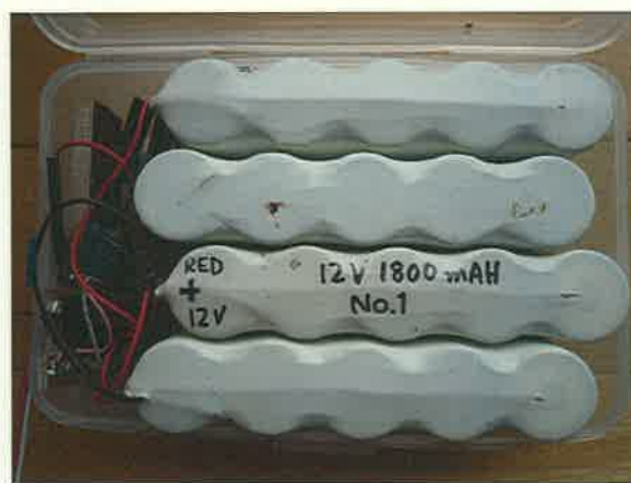
プラスチックケースに組み込んだNi-cd Battery
