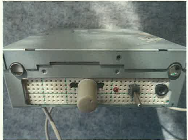
MD Driveのケースに組み込んだPri-Amp
