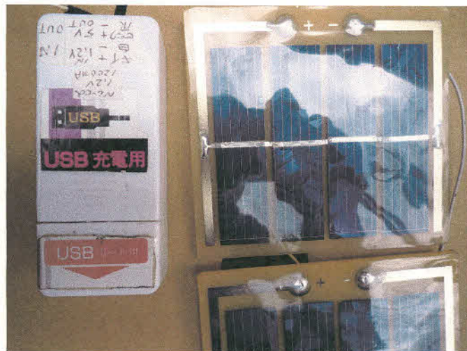
ソーラーパネルの出力はDC/DC Conv.で2.4V→5Vに昇圧
