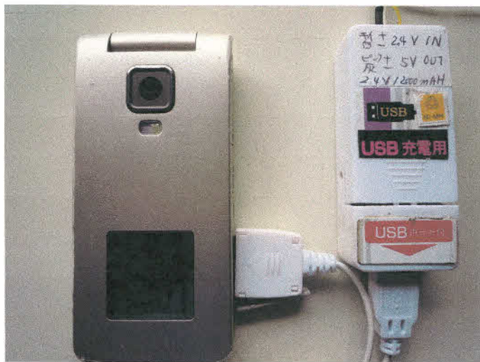
超小電力太陽光発電で携帯電話を充電
