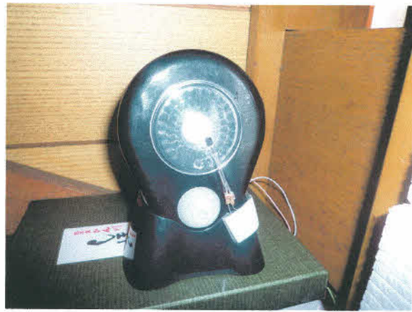
センサーライトにフォトダイオードを取付
